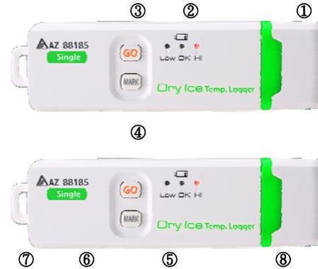
① **USB2.0** 随插即用连接埠. (无需 **USB** 驱动程序, 也无需特定软件.)
