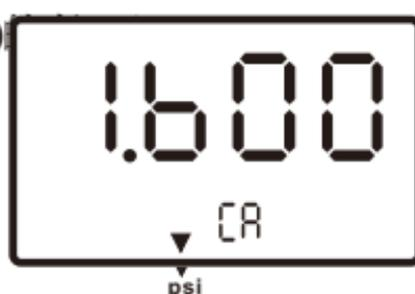
4. 本儀器預設1.6PSI為校正點，且可調整的壓力幅度為1.5到**DIP**若壓力校正值不是1.6PSI可按 **▲** 鍵去增加或按 **▼** 的數值。去減少數值至要求 **REC**
