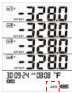
要禁用APO功能，请在开启仪表时同时按下“**⏻**”和**HOLD**。直到LCD上显示‘n’。此非APO模式仅在一个工作周期内有效。一旦仪表关闭并再次开启，将恢复为APO模式。
